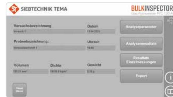
Die Bedienung des Gerätes erfolgt über ein mitgeliefertes Tablet.
