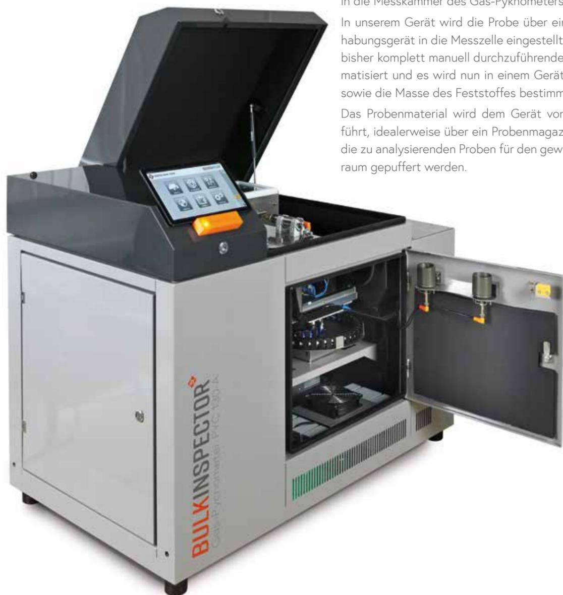
1 Nachdem die Materialprobe in einem Messbecher aufgenommen wurde, wird dieser über ein Handhabungsgerät in die Messzelle eingebracht und dort das Volumen der Probe entsprechend der gewählten Voreinstellungen bestimmt.
